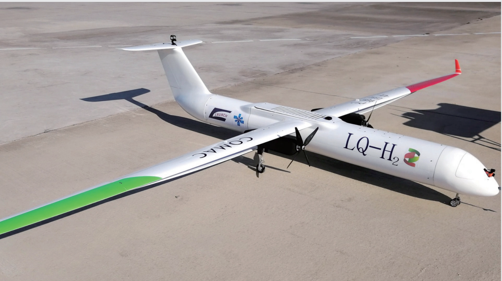
2019 年 3 月，中国商飞“灵雀 H”验证机成功试飞，国家电投研发的氢燃料电池动力系统获验证。
