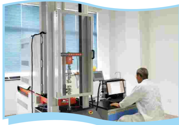
高低温拉力试验机 (台湾高铁)
